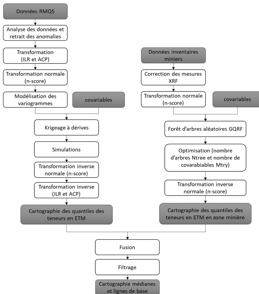
Figure 1 : Représentation des étapes de calcul pour aboutir à une cartographie des lignes de bases pour chaque ETM.
