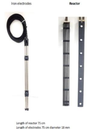
Figure 2 : Electrodes utilisées pour l'EFO
