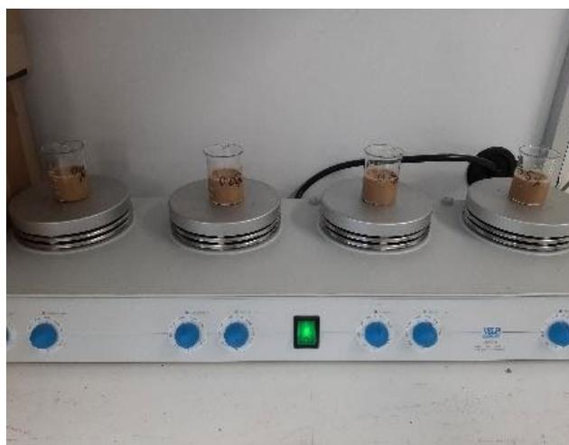
Figure 1 : Préparation des conditions pour le dosage de l'amendement alcalin
