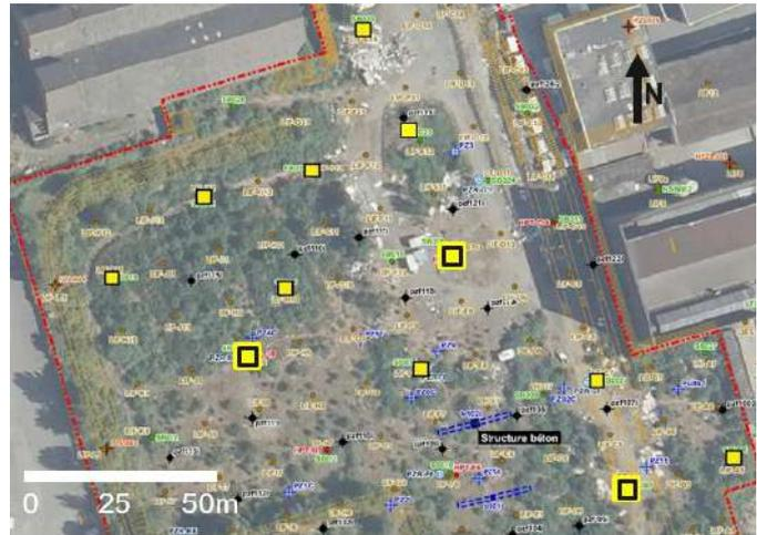
Une répartition des différentes méthodes utilisées sur ce site est représentée Figure 2 : on dispose d'analyses en laboratoire pour tous les sondages, des carottages avec imagerie hyperspectrale (12), des diagraphies HPT/CPT (3) et des diagraphies LIF (9).
