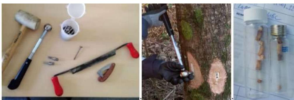
Figure 1 : Matériel et technique d'échantillonnage pour le diagnostic par phytoscreening
